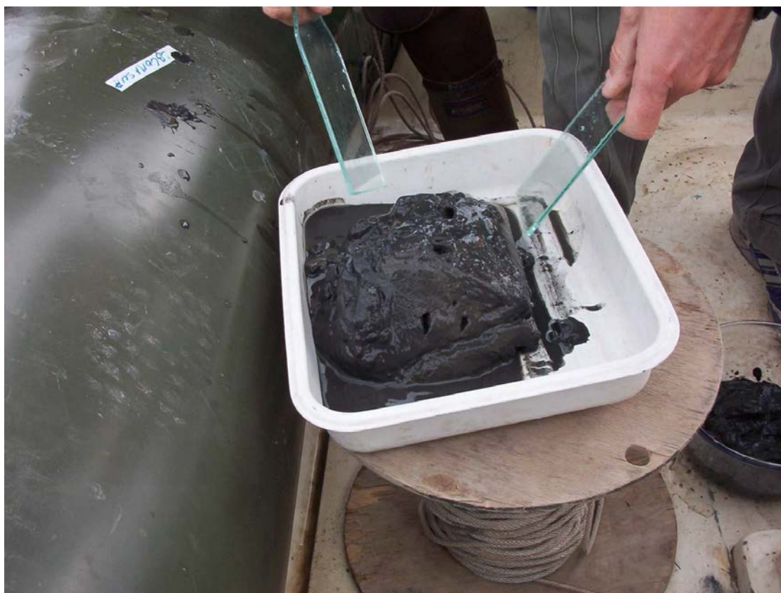
Fig. 3.4 – Homogeneización de los sedimentos de fondo extraídos mediante draga en el embalse Casa de Piedra.
