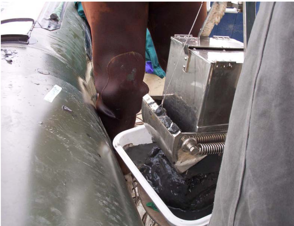
Fig. 3.3 –Draga tipo Eckman empleada en el muestreo de sedimentos de fondo en el embalse Casa de Piedra.
