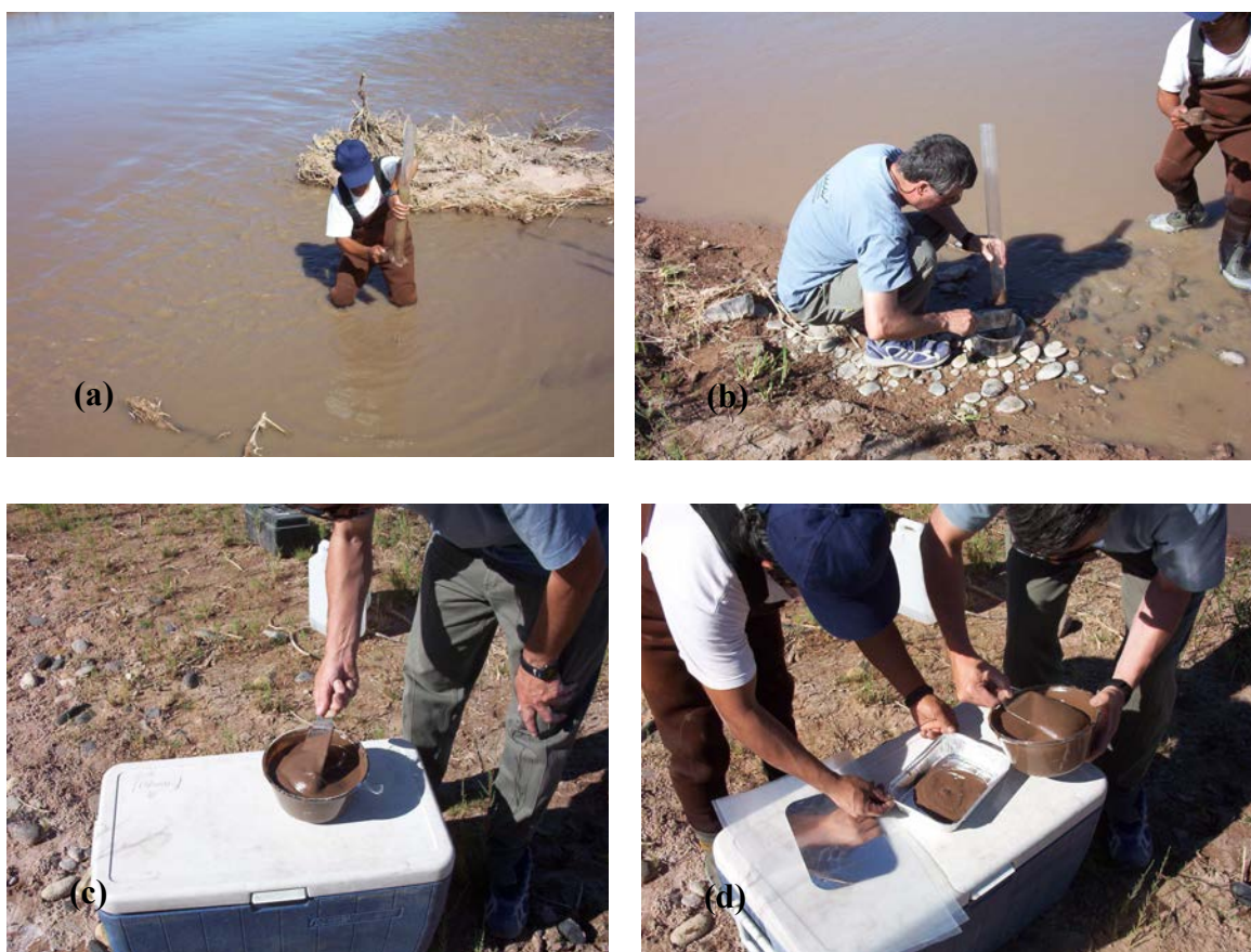
Fig. 3.1 – (a) Muestreo de sedimentos de fondo en el río Colorado mediante un corer de acrílico (b) Submuestreo de las muestras de sedimento (c) Homogeneización de las submuestras y (d) envasado de la muestra homogeneizada de sedimento para análisis de hidrocarburos.
